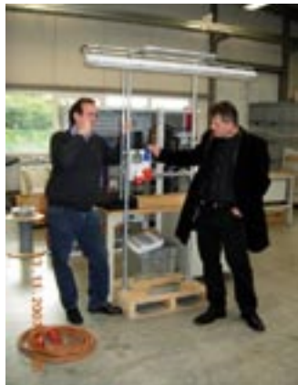
Svetiljka za osvetlitev cevovoda, v ozadju elektro omarica za vmesno črpalko
