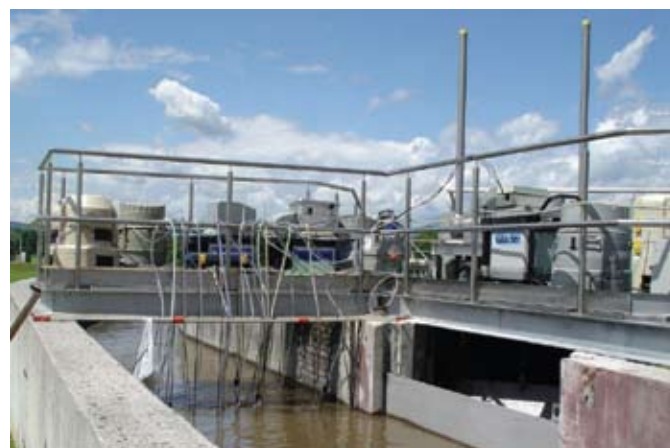
Medlaboratorijska primerjava vzorčenja odpadnih vod: vzorčenje z avtomatskimi vzorčevalniki.
