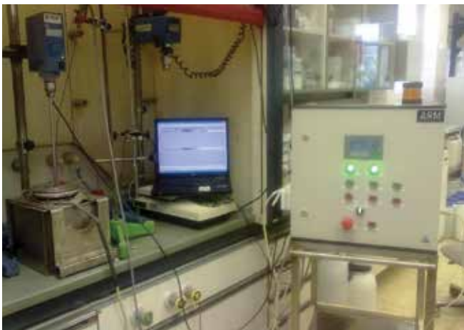
Slika 3: Laboratorijski reaktor (reaktor z mešalom, ARM omarica in računalnik).
