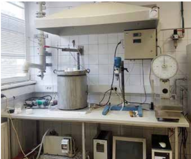
Slika 4: Pilotna razklopna naprava (reaktor z grelcem zraka, pokrov reaktorja z nameščenimi temperaturnimi tipali, dimnik s sondo za pretok plinov, napa, parni generator, črpalka, mešalo in tehtnica, priključek za zrak, ARM omarica in računalnik).
