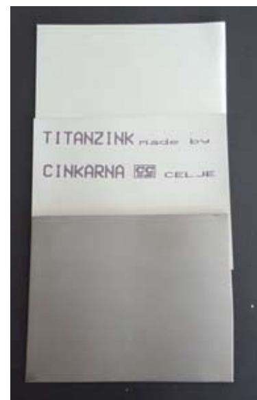
Vzorci predpatinirane pločevine
