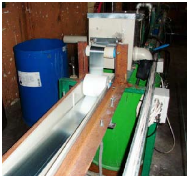
Pilotna linija za predpatiniranje pločevine
