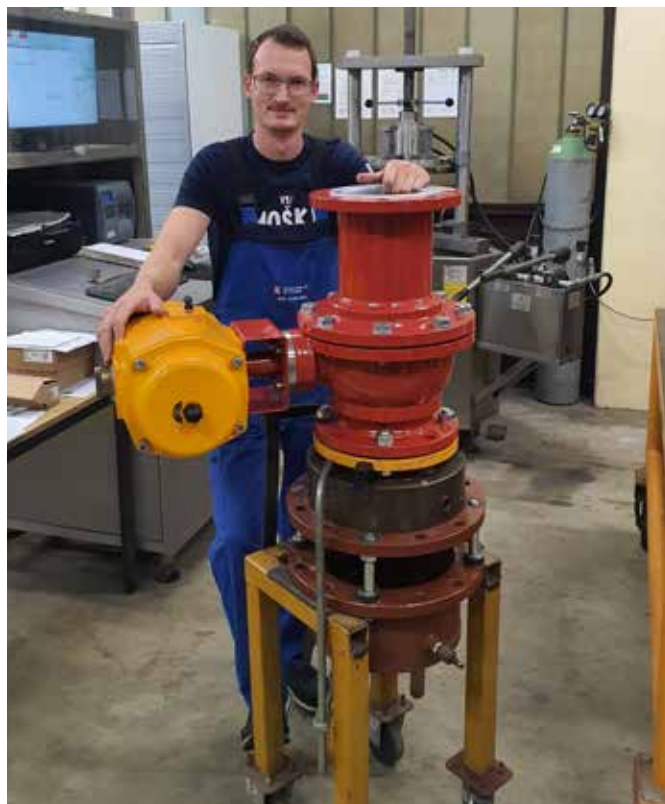
Teflonirani krogelni ventil DN150, cinkarniški največji krogelni ventil, je bil tema diplomskega dela sodelavca Jureta Vrbovška. (Foto: Andraž Osetič)
