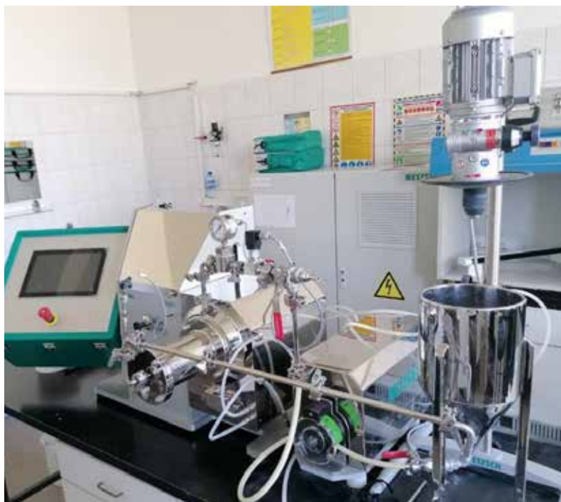
Umestitev laboratorijskega peščenega mlina v laboratoriju. (Foto dr. Nika Veronovski)
